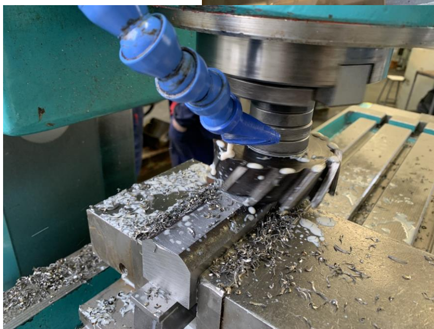
foto: frézování opěrky
