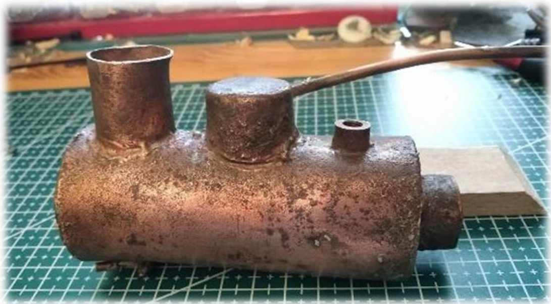
Obrázek 39: Spájený kotel z boku
