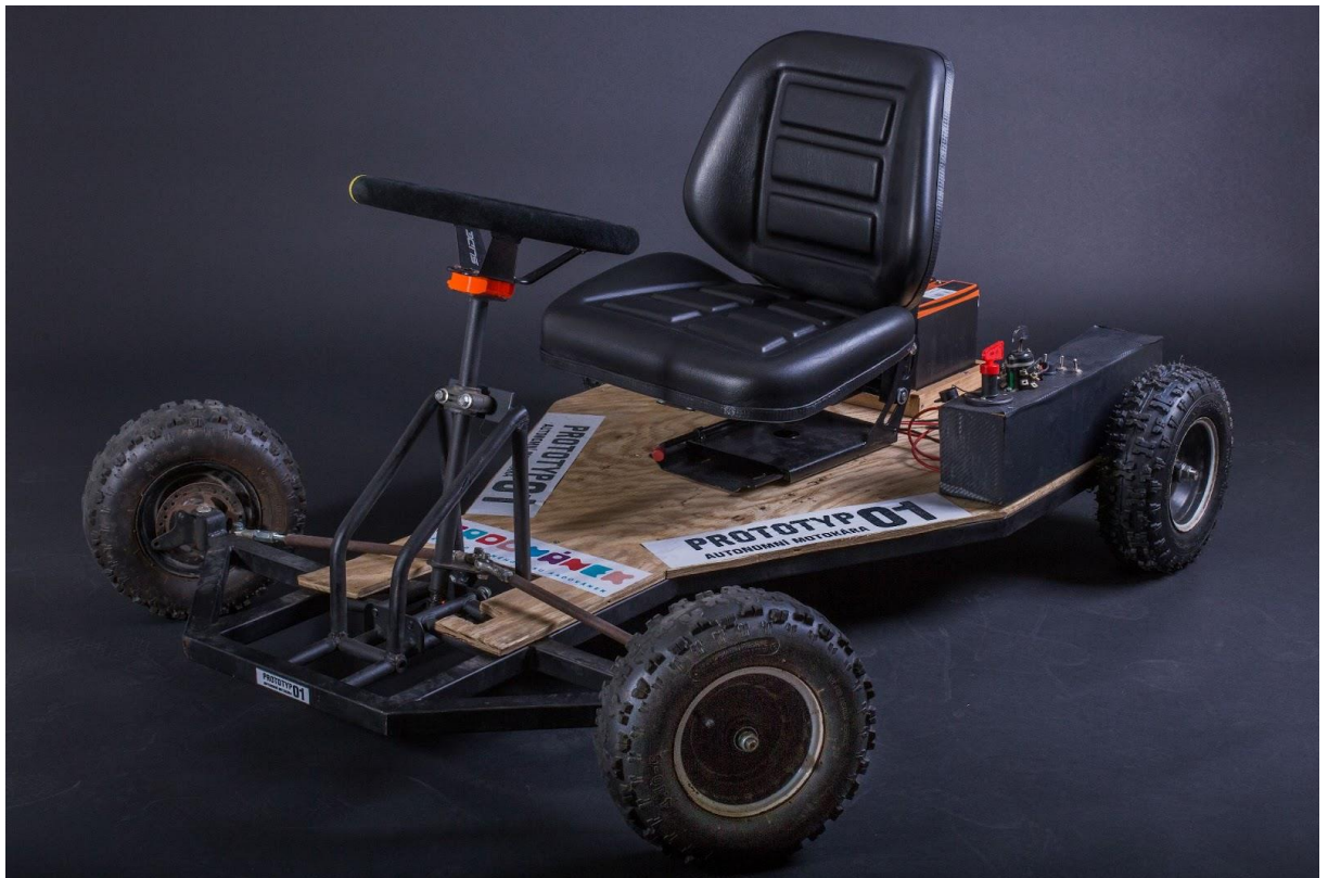
Obr. 1: Fotografie prvního prototypu naší motokáry bez autonomních prvků, světel a kovového uchycení volantu
