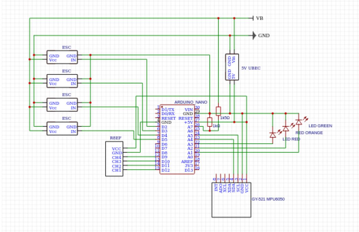
Jak je ze schématu patrné, kromě mikrokontroléru jsou na dronu přítomné ještě čtyři další různé komponenty, plus motory. Začneme od baterie. Celý tento systém samozřejmě potřebuje napájení a jelikož motory dokáží spotřebovat velké množství energie, vyбрали jsme relativně velkou 11.1V baterii o kapacitě 4500 mAh. Díky této baterii je možné létat s naším dronem po dobu přibližně patnácti minut.
