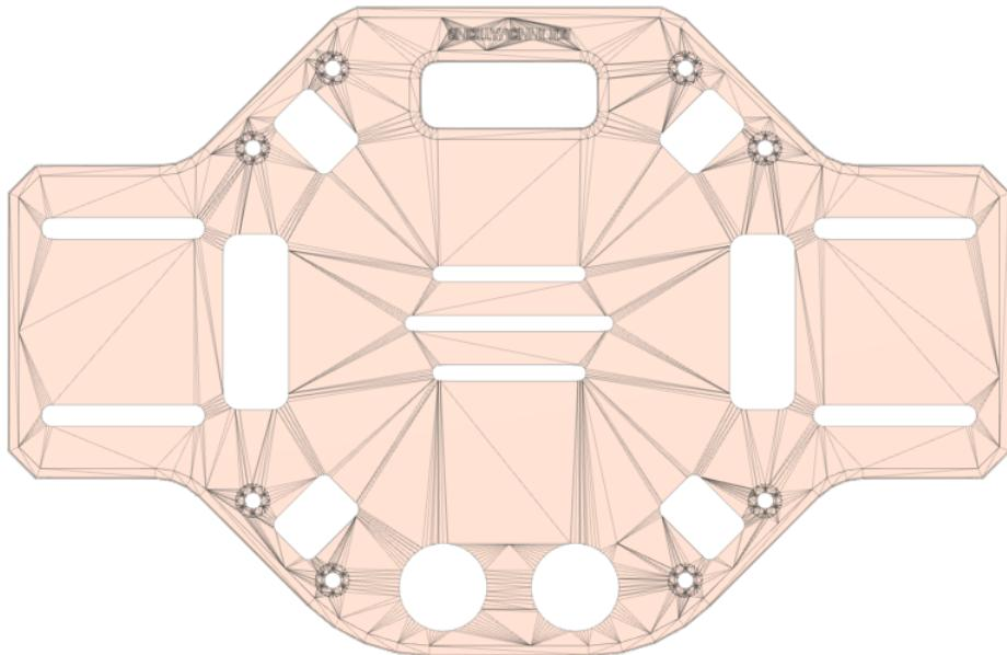
Dále z horní strany přilehne vrchní deska o rozměrech 10.7 x 10.7 cm. Tato deska kromě toho, že umožňuje držet celou konstrukci pohromadě, také slouží jako podpora pro mikrokontrolér a další elektroniku. Právě na této desce bude totiž přimontovaný mikrokontrolér, spolu s dalšími senzory včetně přijímače pro dálkové ovládání. Z tohoto místa tedy vychází veškeré řízení dronu. Model horní desky je opět přiložen níže.
