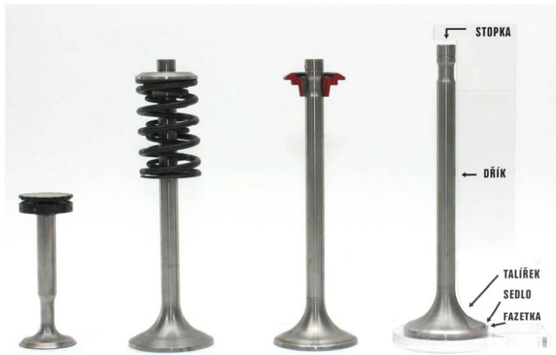
Ventil - hlavní detail spalovacího motoru
