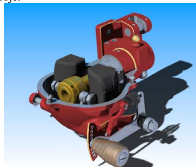
(obr 3.2) Odstředivý regulátor renderovaný v SolidEdge
