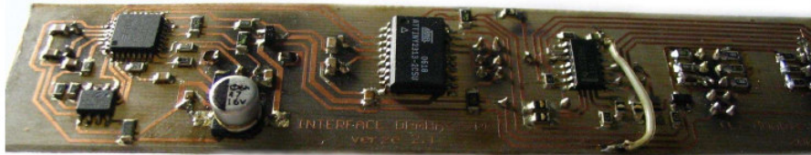
Obr. 2 Osazený a otestovaný interface
