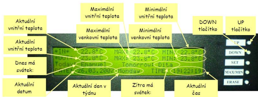
Obr. 7: Popis displeje a tlačítek hlavního panelu- A
