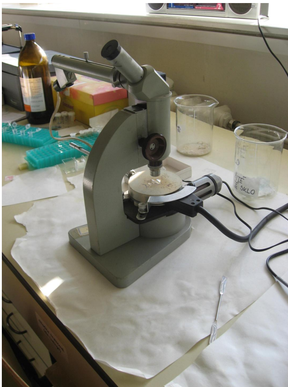
Obr.6: Koflerův blok – přístroj na stanovení teploty tání
