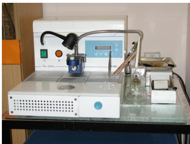
Obr. 8: Zalévání vzorku do parafinových bločků
