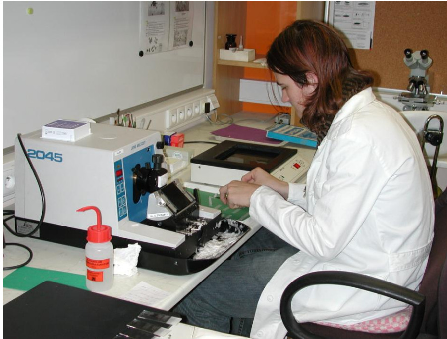
Obr. 10: Krájení na rotačním mikrotomu
