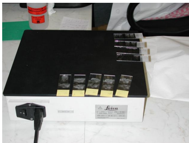
Obr. 9: Sušení řezů na horké ploténce
