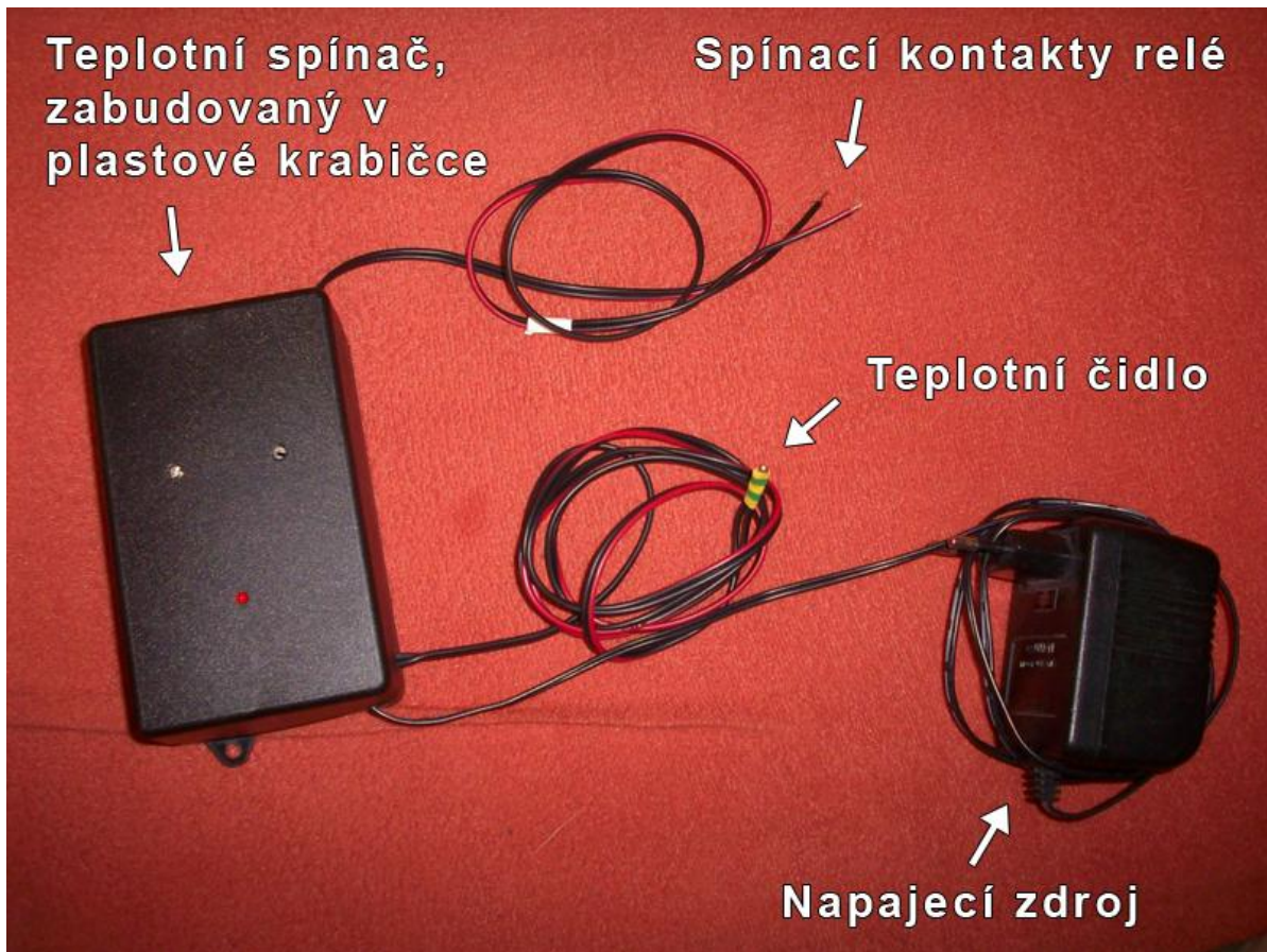
Obr. 5 Námi zhotovená automatická regulace
