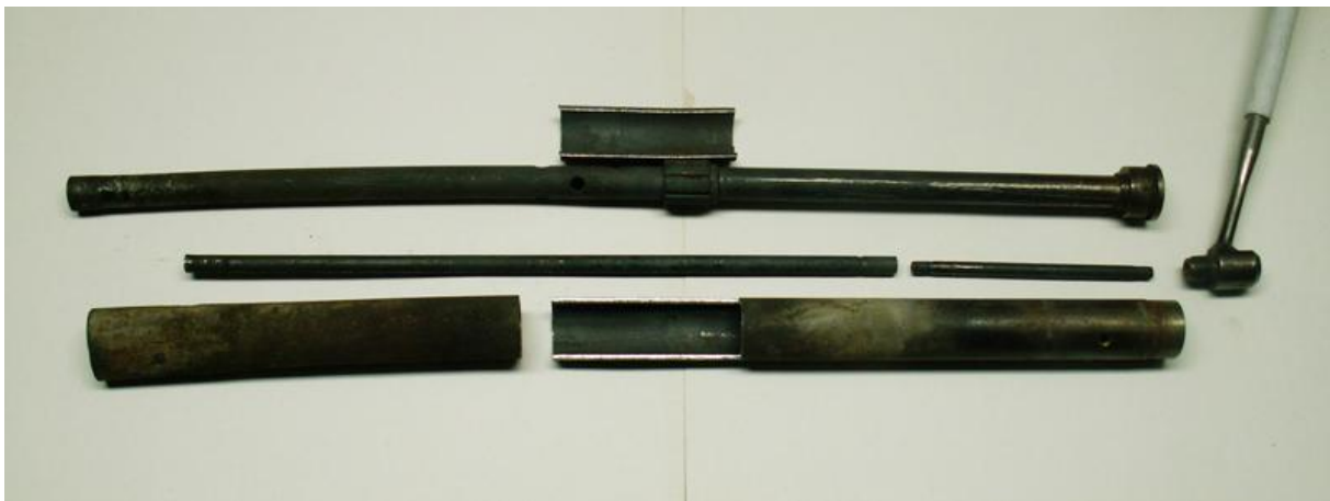
Obr. příloha/ 3 Fotografie rozložené trysky
