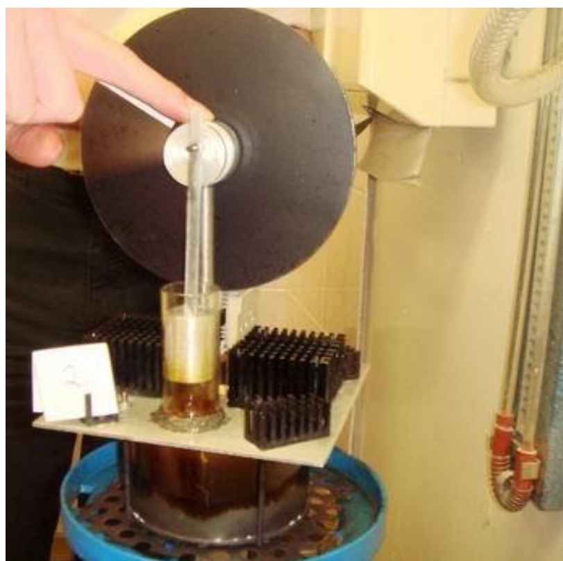
Stirlingův motor při rozbíhání nad kahanem – foto
