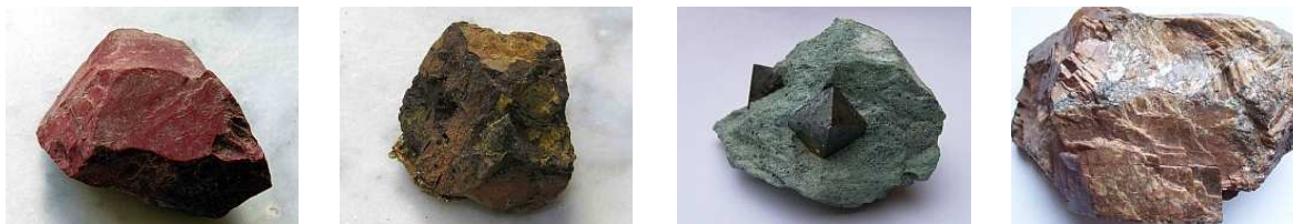
Obr.2.,3.,4.,5. Charakteristické ukázky železných rud. Z leva do prava – Hematit, Limonit, Magnetovec, Ocelek.
