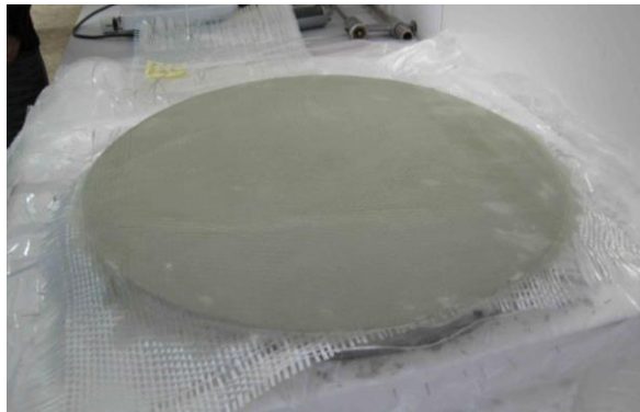
Obr. 9: Vytvrzený laminát na matrici
