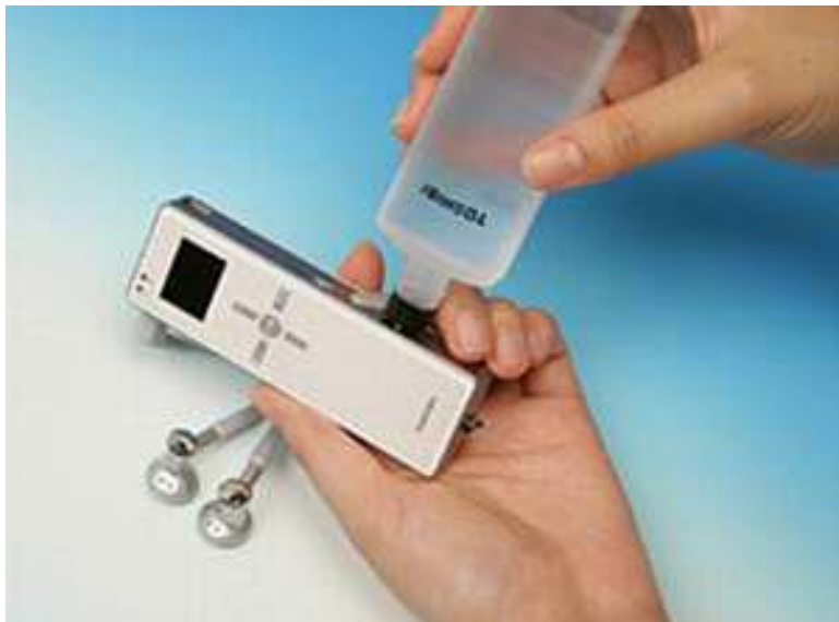
Plnění metanolového palivového článku zabudovaného v MP3 přehrávači firmy Toshiba.
