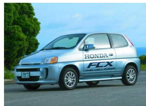
Honda FCX je poháněna palivovým článkem
