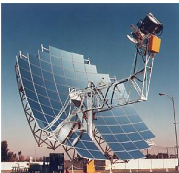
Obr. 11 Solární jednotka SES, 25 kW
