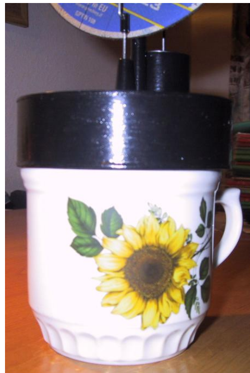
Tepelný zdroj – hrnek s převařenou vodou (100°C)
