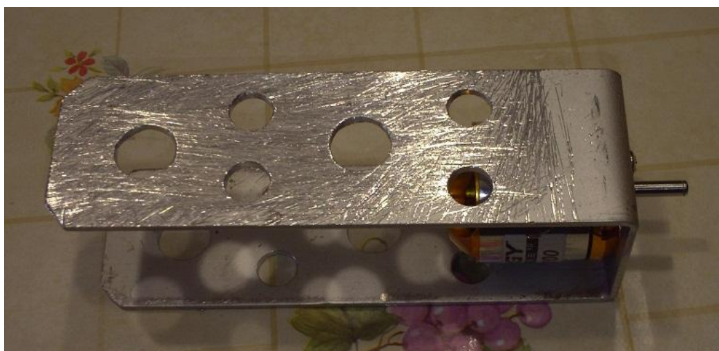
Obr. 2: Motorová přepážka, pohled z boku, uchycení k polystyrenu pomocí lepidla epoxy
