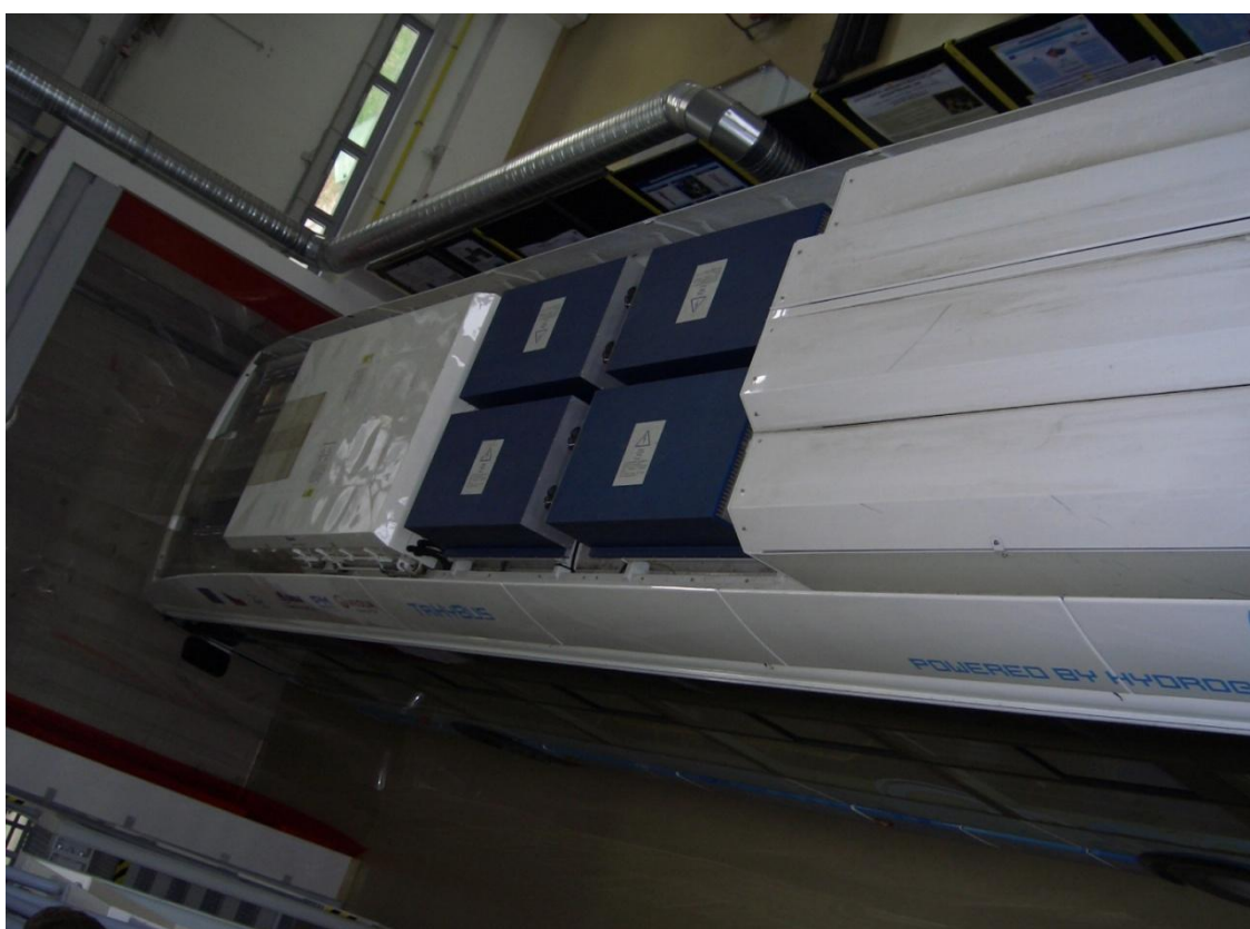
Obr. 8 – střecha autobusu (elektronika, kapacitou, nádrže na vodík)
