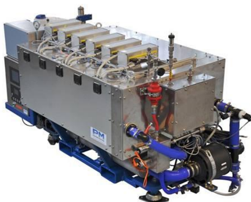
Obr. 3 – palivový článek pohánějící TRIHYBUS
