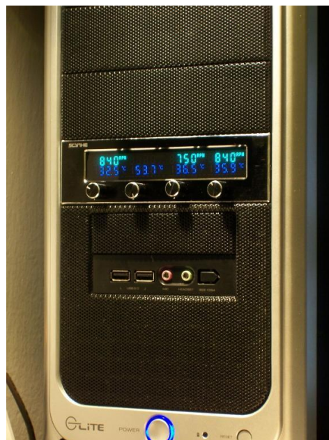
17) Manuální regulační panel od firmy Scythe
