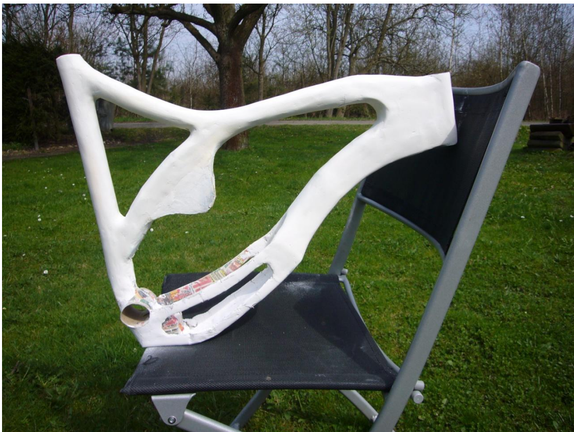
Obr. 7: Hotová přední stavba rámu
