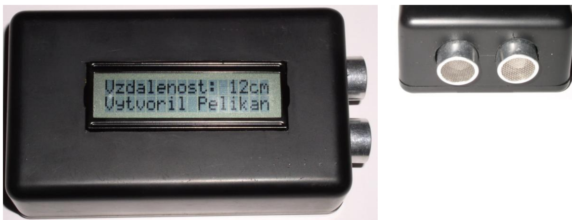
Obr. 5 Hotový měřič vzdálenosti a pohled na ultrazvukové snímače
