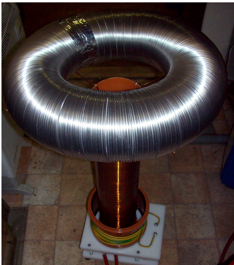
Sestavený teslův transformátor bez zdroje VN
