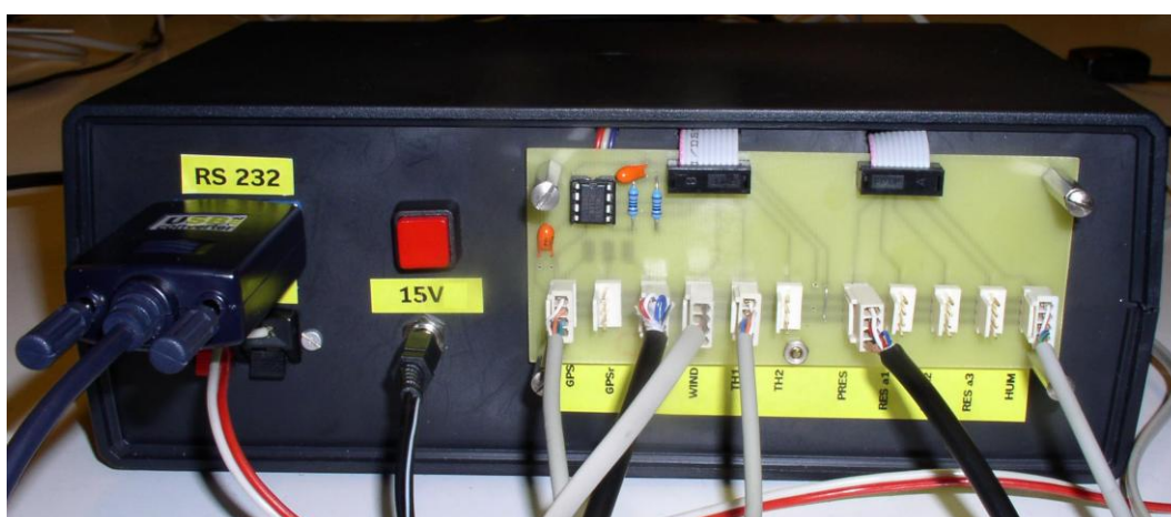
Obr. 2 Zadní panel s připojením snímačů
