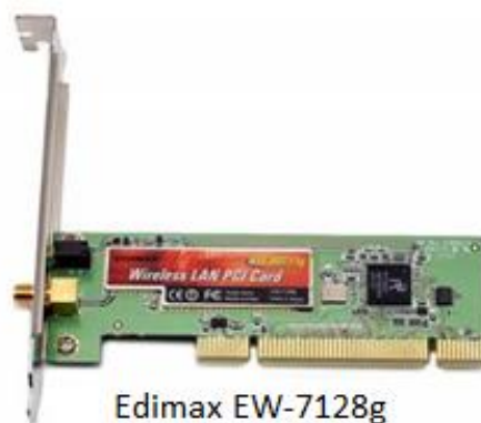
Obrázek č. 9. PCI sloty 32(krátké), 64 bitové (dlouhé). Wifi karta pro rozhraní PCI
