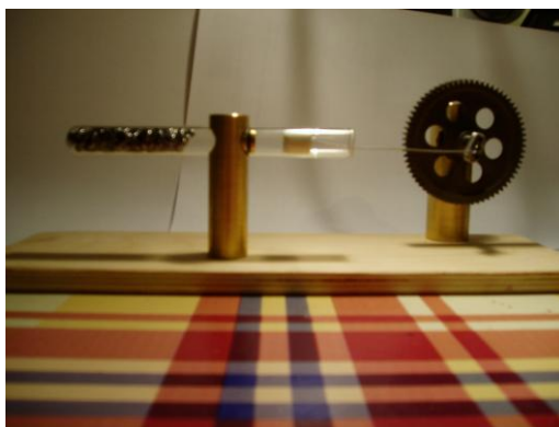
Motor 17 - První pokus o výrobu termoakustického motoru.
