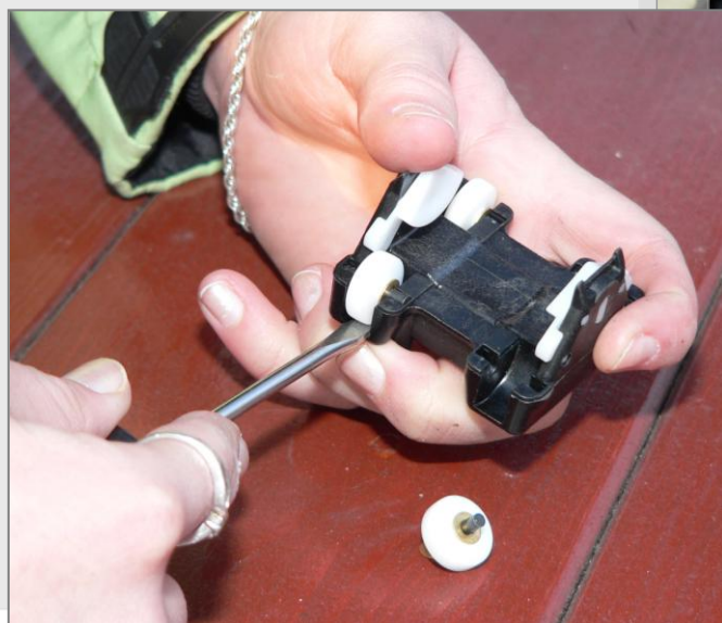
Výměna kluzáku – (měníme pomocí špice)
