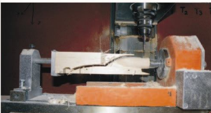
Obr. 22. Upnutí modelu v dělicím přístroji DP2
