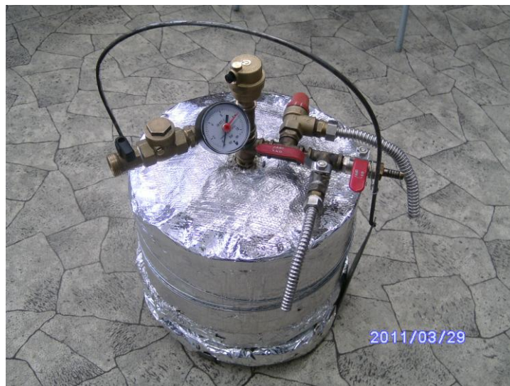
Jeden z možných zdrojů páry - parní kotel z PB lahve (včetně pojistného zařízení), kotel je třeba tepelně izolovat z důvodu zabránění úniku tepla
