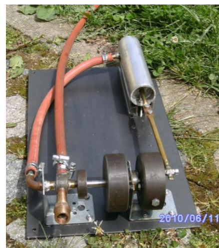
Starší typ PM při testování výroby páry pomocí sluneční energie na dvoře naší školy
