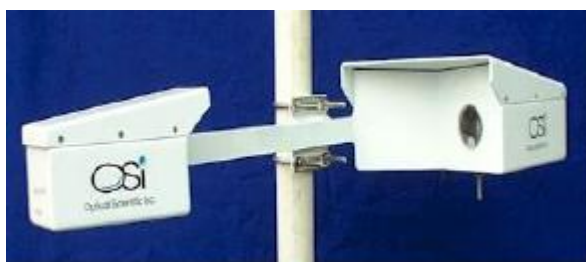
Obr.č.6: Optický srážkoměr
