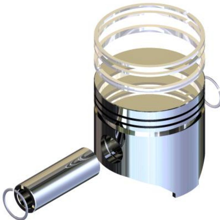
Obrázek 5: Píst s pístními kroužky, čepem a pojistkami
