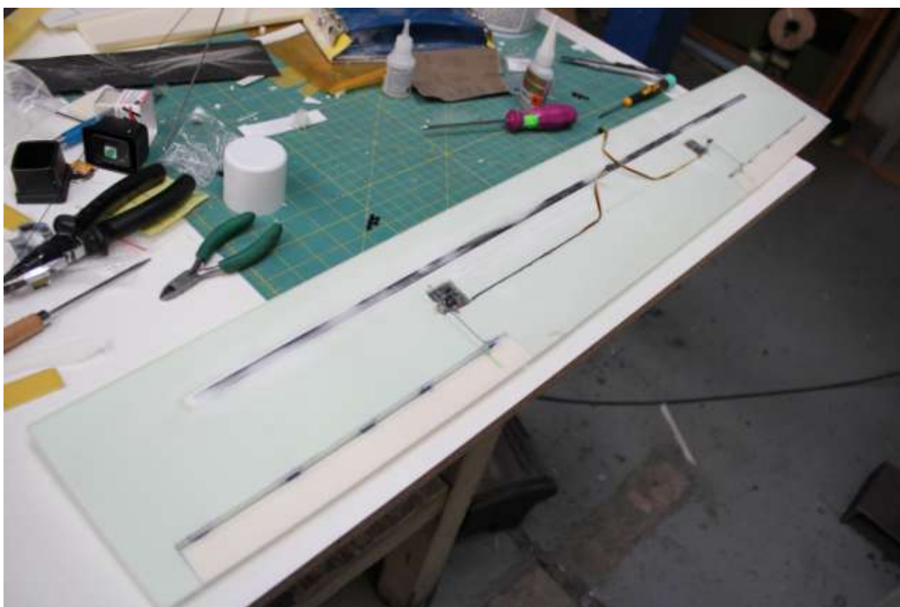
Serva jsou už na svém místě, spojená s křídélky pomocí táhel
