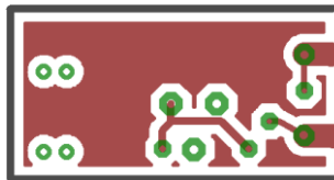
Obrázek 56 : Předloha desky optické závory strana BOTTOM 1:1
