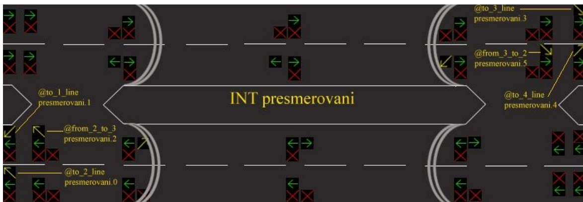
obr. 9 Rozložení jednotlivých bitů na danou LED proměnného značení
