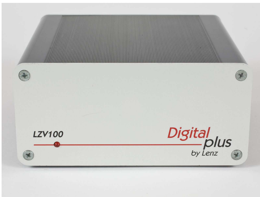
Obr. 6 – Řídicí stanice od firmy Lenz
