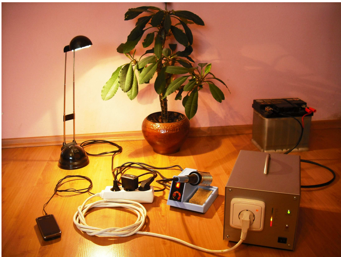
Obr. 20 – Dokončený měnič napětí
