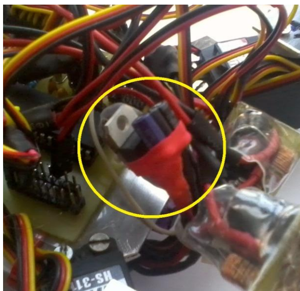
(Obr. 3.5) Stabilizátor uvnitř smršťovací bužírky
