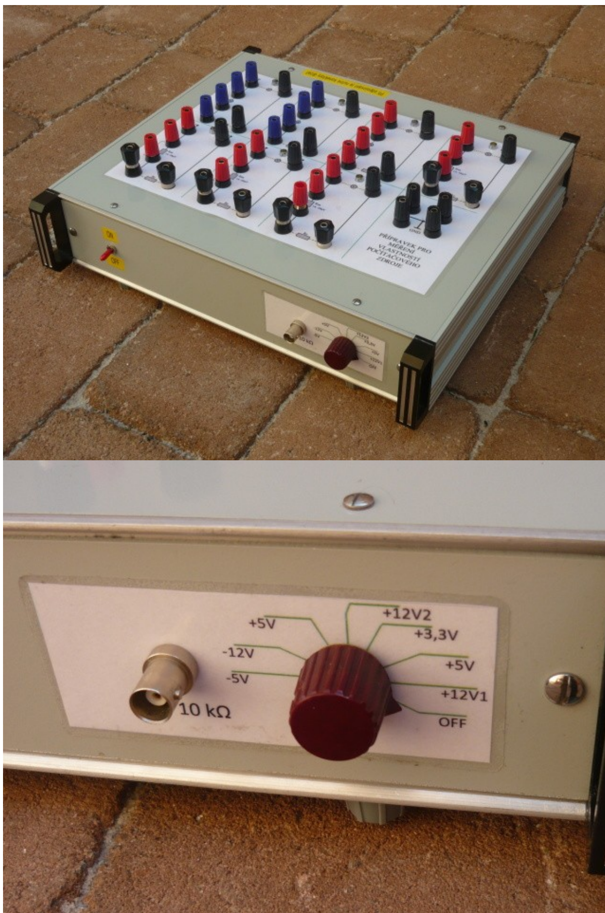
Fotografie přípravku pro měření vlastností počítačového zdroje
