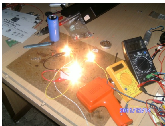
Při rezonančních otáčkách žárovky svítí na max.
