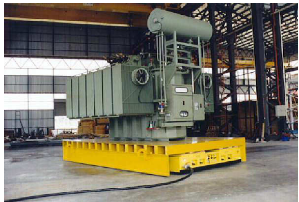
Obr.3 Manipulace s transformátorem
