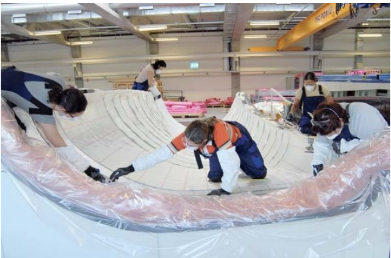
Obr.21: Výroba listu rotoru ve firmě Enercon, práci vykonávají ženy!
