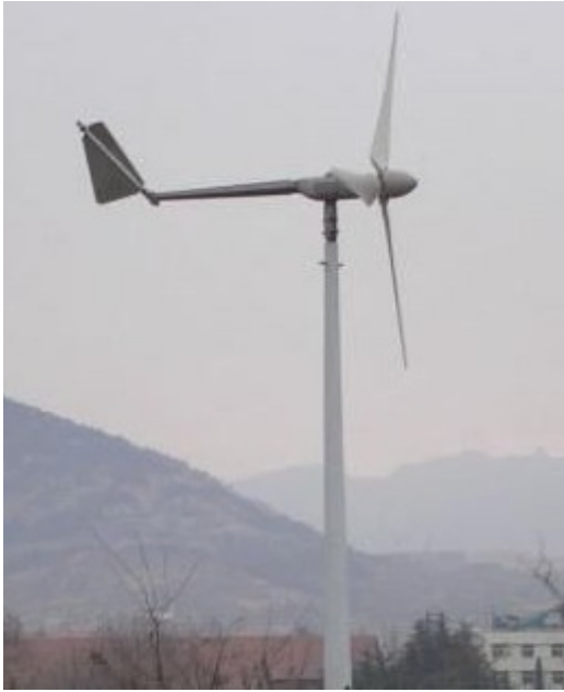
Obr.13: Ostrovní elektrárna WHF2KW
