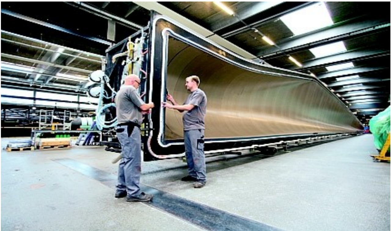
Obr.20: Forma na výrobu listu
