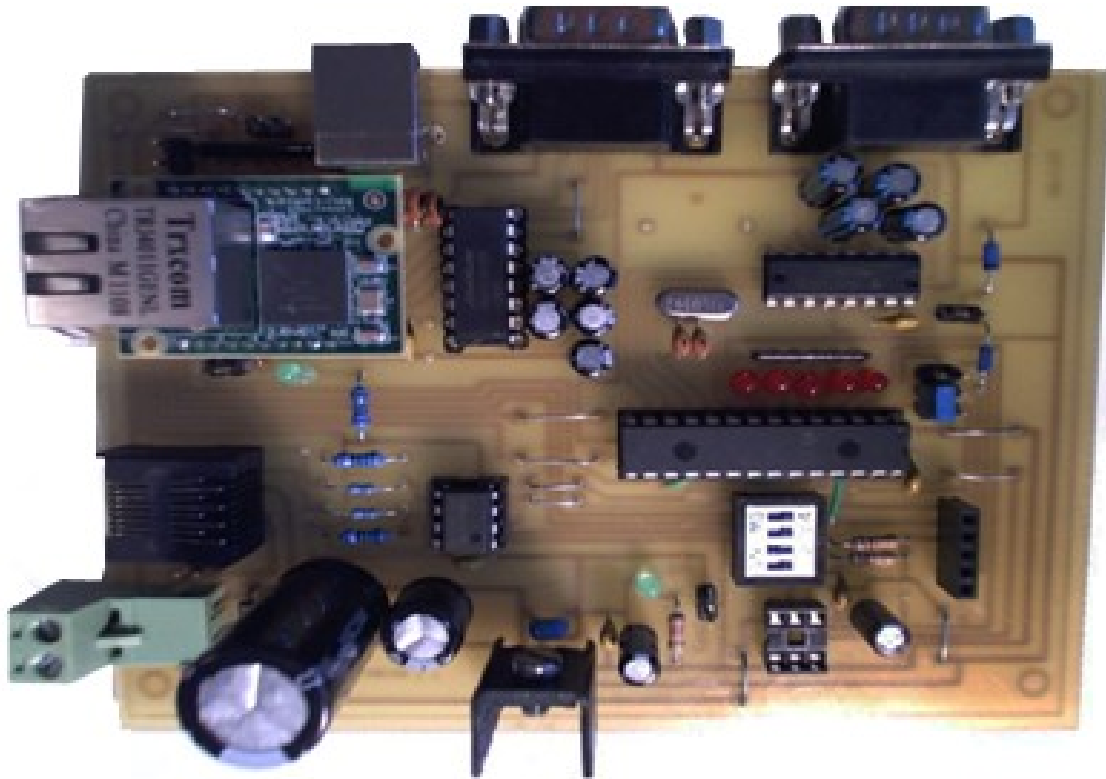
Obr. 2: Pohled na řídicí jednotku
