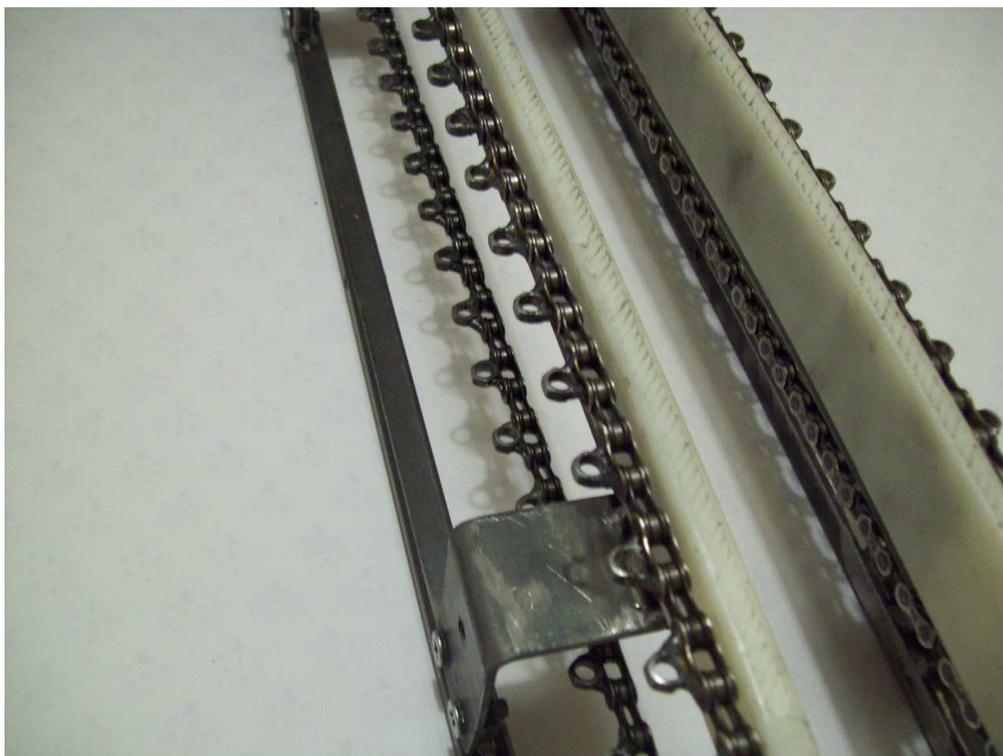
Obrázek 17: Kostra modelu s přišroubovanými podpůrnými držáky pásu
