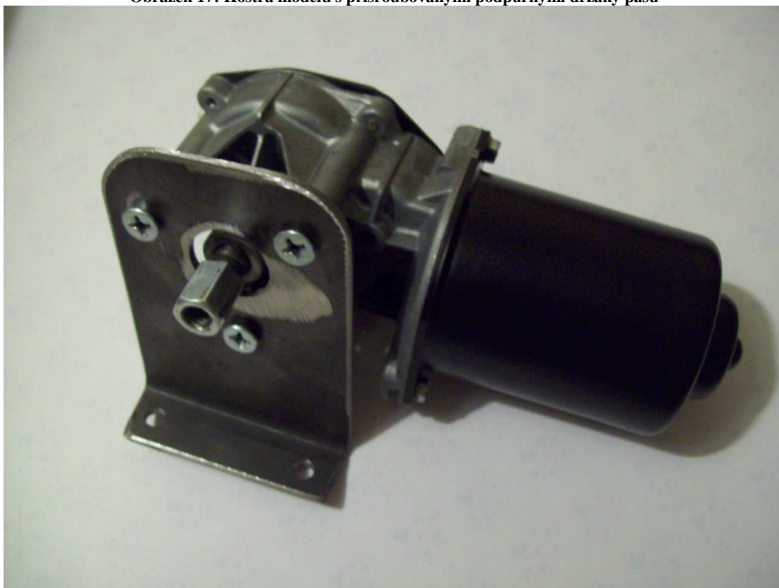
Obrázek 18: Motor s přišroubovaným držákem pro přichycení ke kostře
