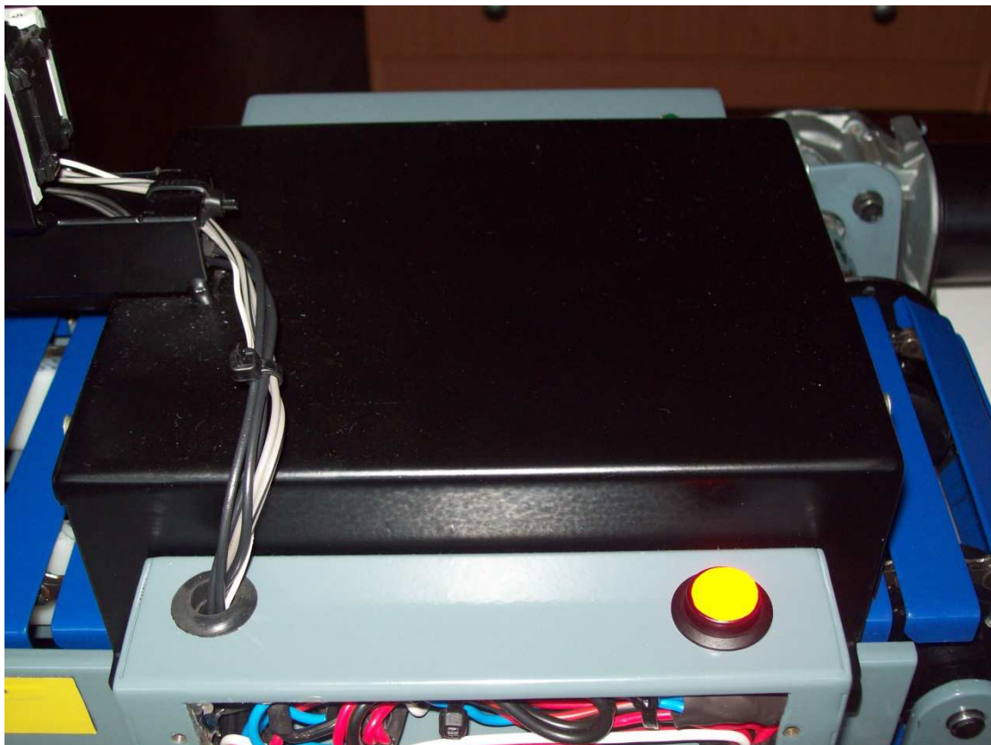
Obrázek 22: Detail tunelu s přišroubovanými rozvodnými skříněmi
