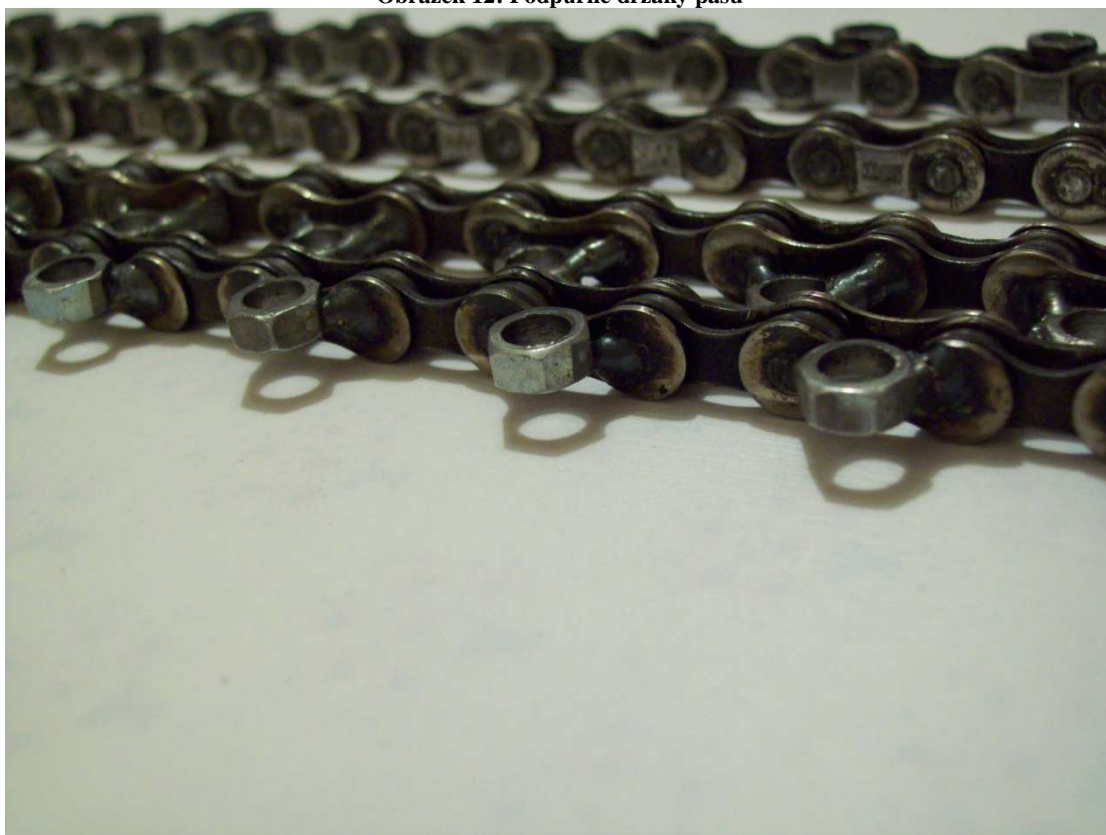
Obrázek 13: Detail řetězu s navařenými maticemi M4
