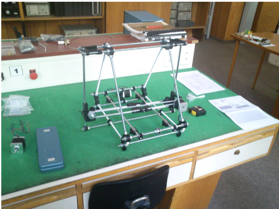
Obr.5: Holá mechanická konstrukce tiskárny (zdroj: vlastní foto)
