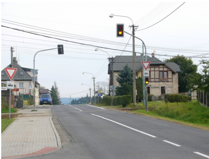
Obrázek č. 19 - Křížení tramvajové trati se silnicí – řízeno pomocí světelné signalizace, nikoliv jako u drážních přejezdů výstražníky VUD,(AŽD). Zdroj: [3]
