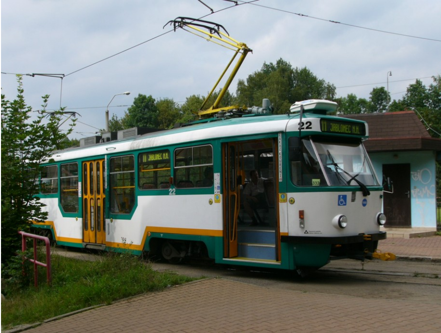
Obrázek č. 21 - Repasovaná tramvaj T3 s nízkopodlažní částí a polopantografem Zdroj: [3]
