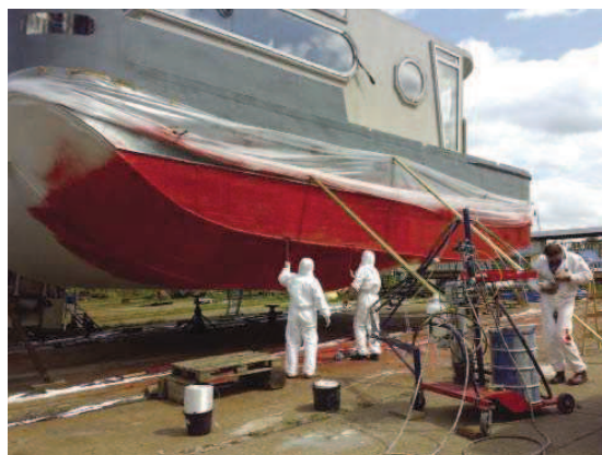
Obrázek 12 Stříkání plastu na trup lodi[8]
