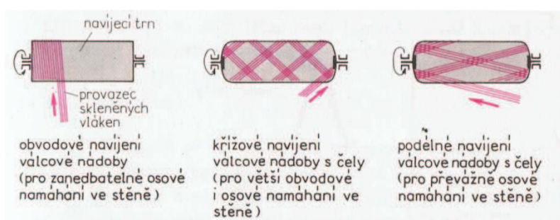
Obrázek 12 Schéma způsobů navíjení skelného laminátu[1]
