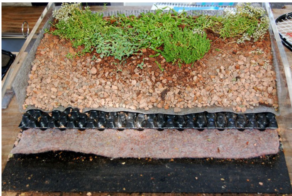
Detail a řez konstrukční skladbou zelené střechy.
