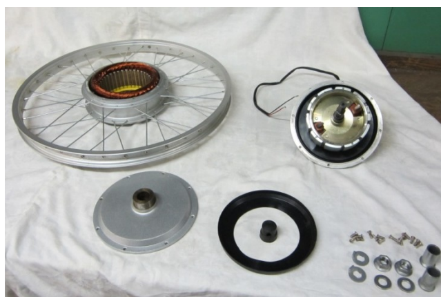
Obr. 9 Rozebraný motor DB22 36V00406F0131
