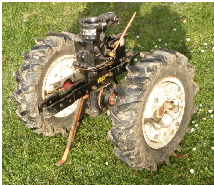
Obrázek 3 Převodová skříň – skutečná
