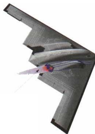
Obrázek 8 (Znázornění ochlazování horkého vzduchu z motoru)
