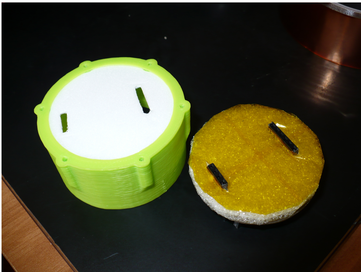
Obrázek 4.4: Tepelná izolace mezi elektronikou a senzory
