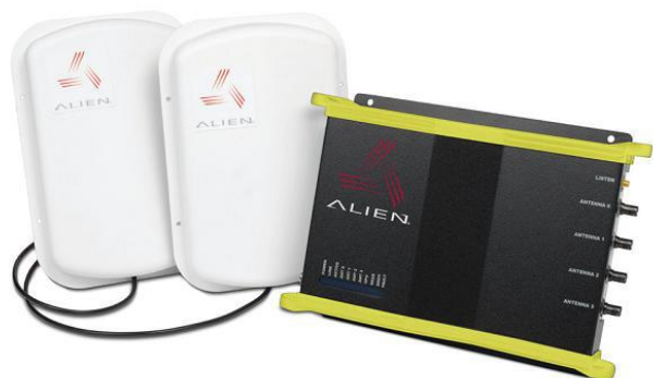
Obr. 8 Stacionární RFID čtečka
