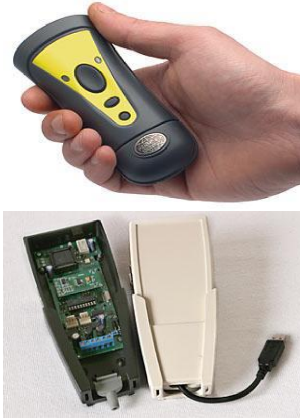
Obr. 10 Ruční RFID čtečka
