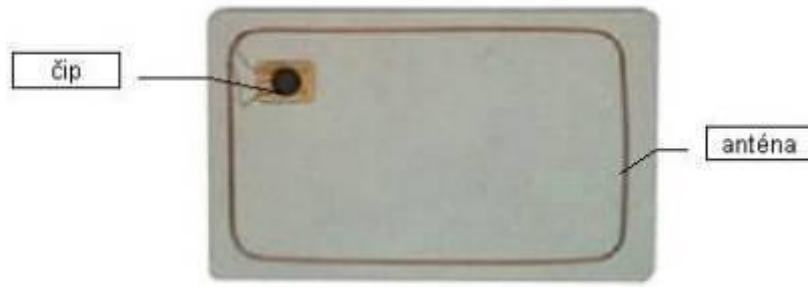
Obr. 2 Pasivní RFID karta
