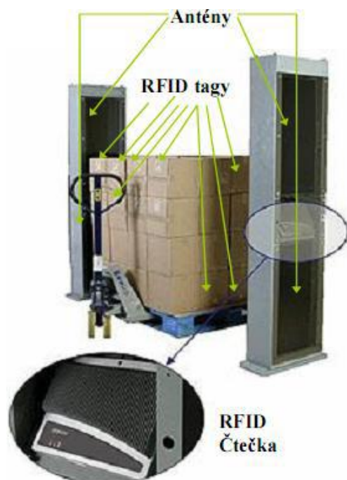
Obr. 8 Stacionární RFID čtečka
