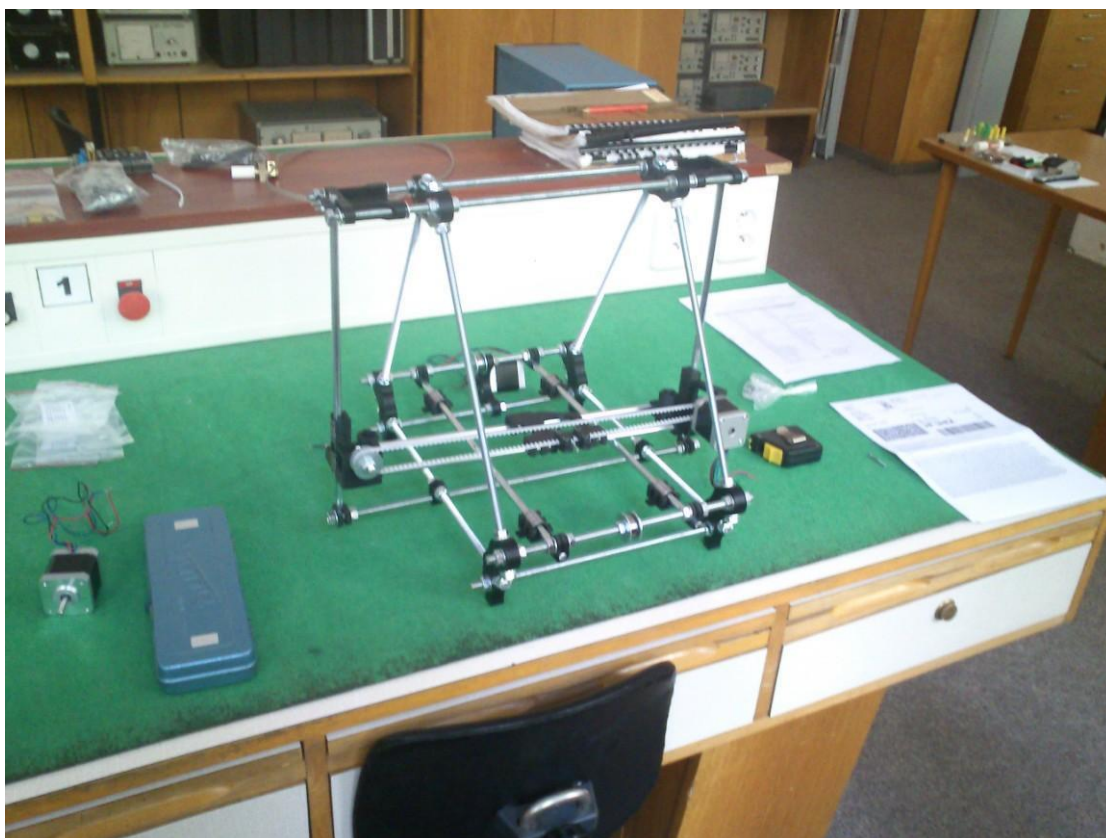
Obr.5: Holá mechanická konstrukce tiskárny (zdroj: vlastní foto)
